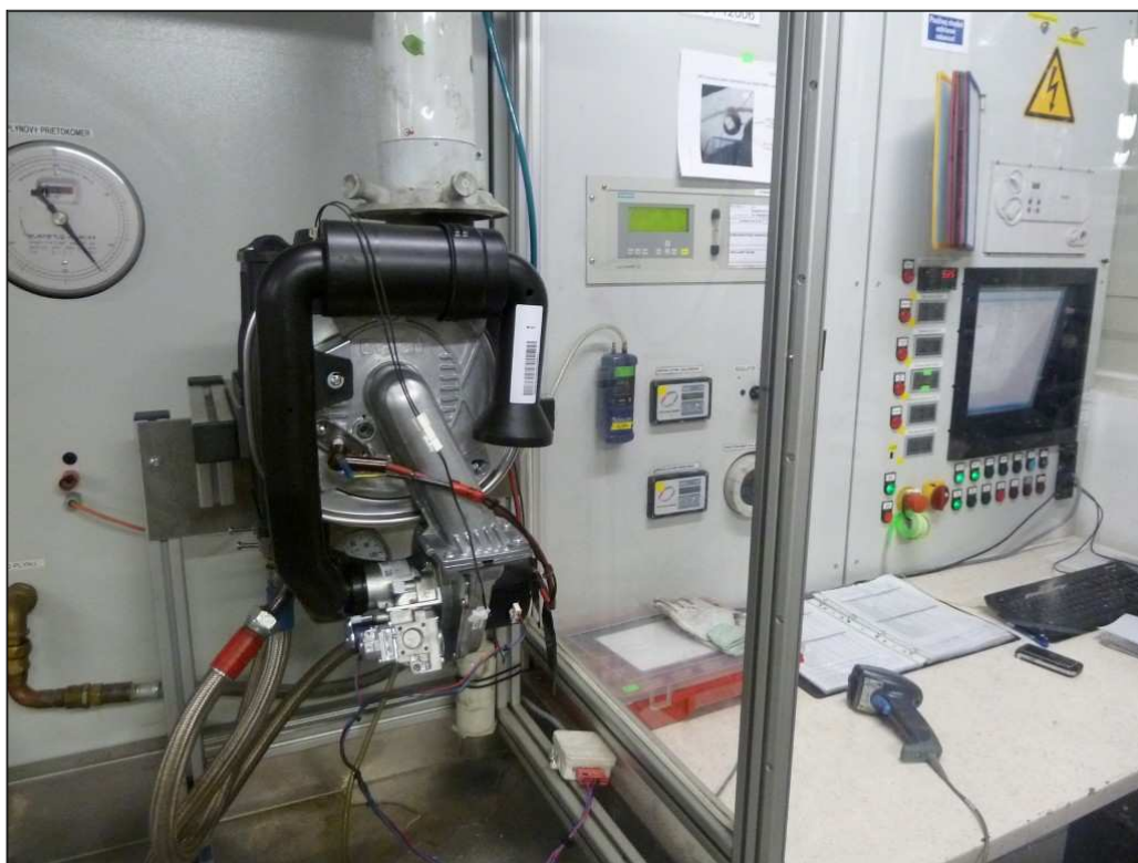
Obr. 20 Tester plynových spařovacích modulů na Shipping audite
