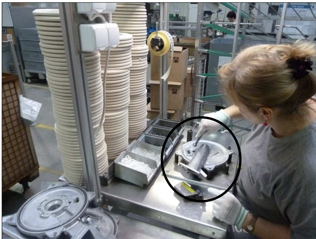
Obr. 17 Proces předmontáže zmiešavacieho ramena
