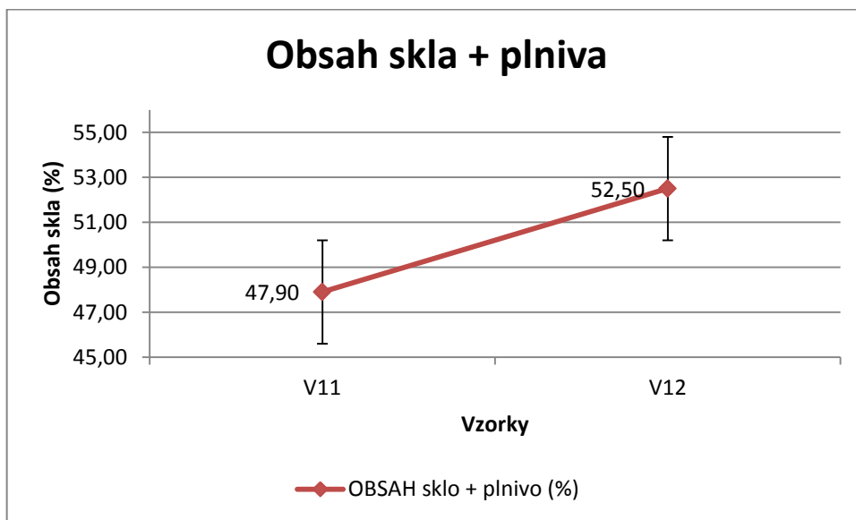
Obr. 31. Grafické znázornění obsahu skla u vzorků bez gelcoatové vrstvy.
