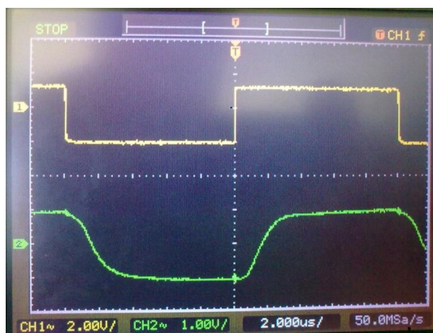
Obrázek 11: Uložený průběh signálů pro frekvenci 50 kHz
