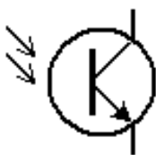
Obrázek 14: Schématická značka fototranzistoru [21]
