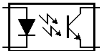
Obr. 1: Schématická značka optronu
