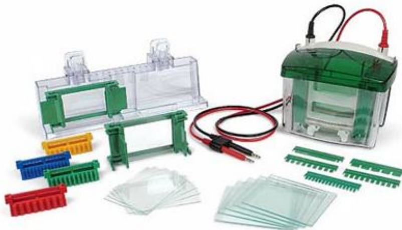
Obrázek 22: Aparatura pro SDS-PAGE Mini-PROTEAN Tetra Cell (BIO-RAD Laboratories, USA) [77]
