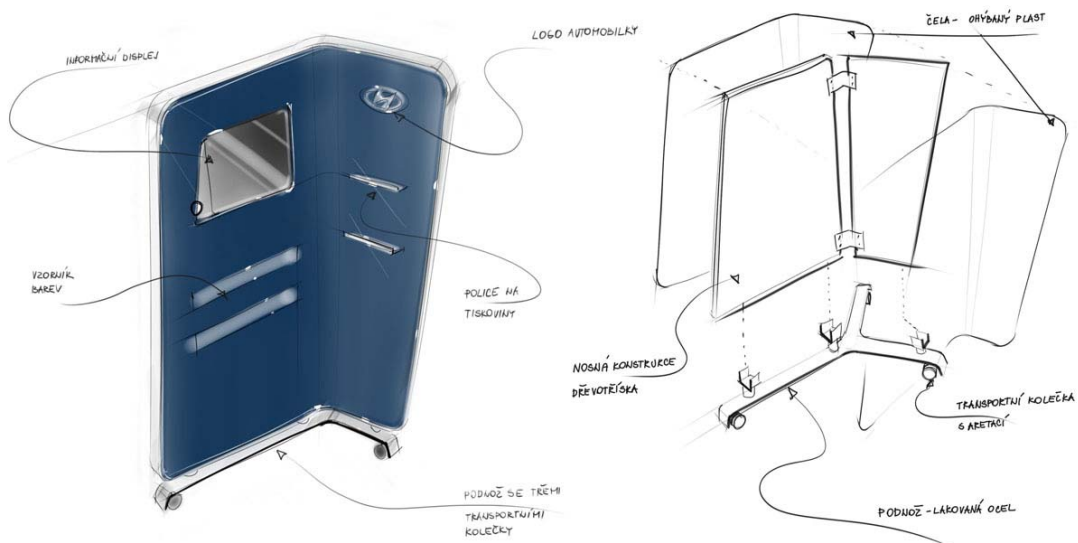
Obr. 16. Jeden ze stojanů konečného řešení – funkce a materiály
