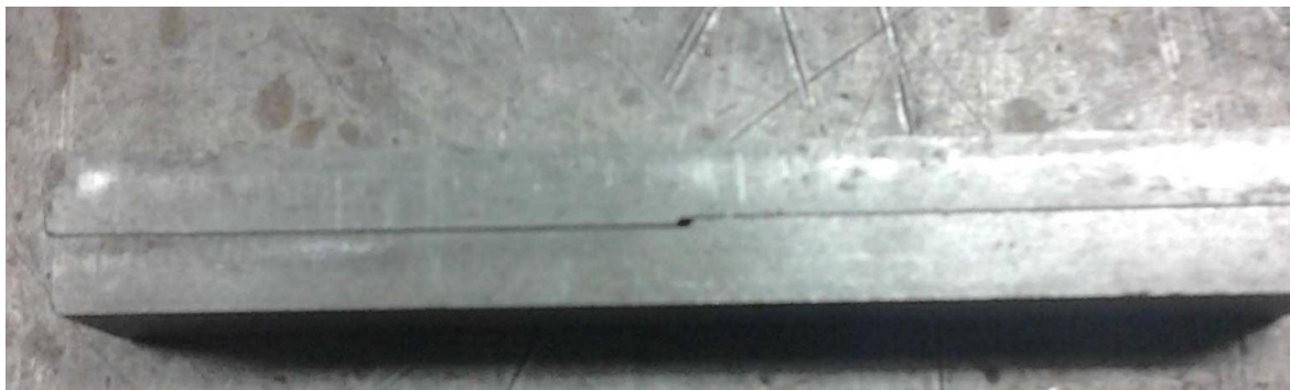
Obr. 12 Přípravek na úpravu plechu pro zkušební tělíska
