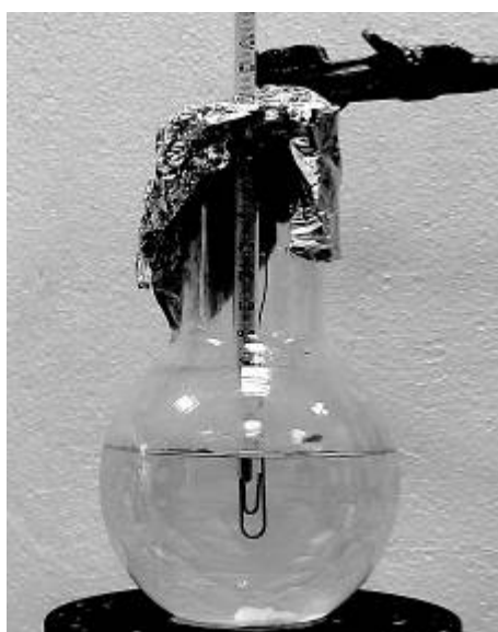
Obrázek 14 Detailní záběr na úchyt vzorku
