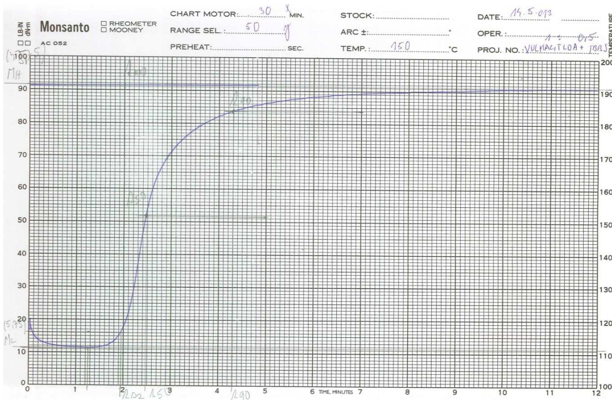
Pří. 26. Vulkacit LDA+TBBS v množství 1DSK+0,5DSK při 150°C
