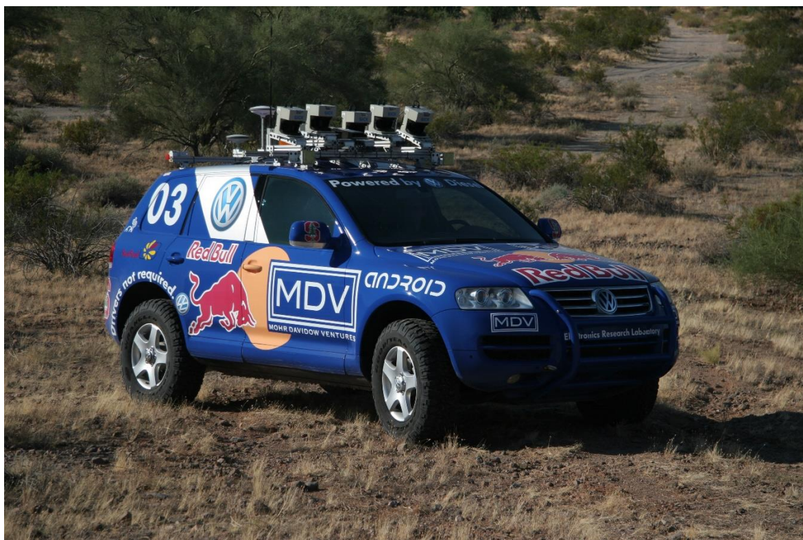
Obrázek 1: Autonomní robotický automobil Volkswagen Touareg, Stanley [29]
