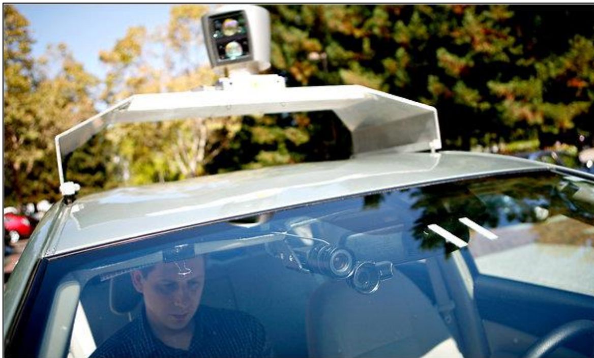
Obrázek 20: Umístění LIDARu na střeše auta Google Car. [27]
