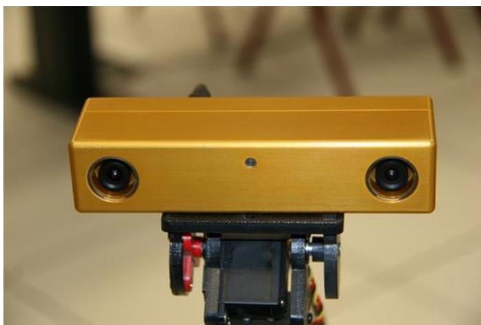
Obrázek 2: Takto může vypadat stereo kamera. [19]
