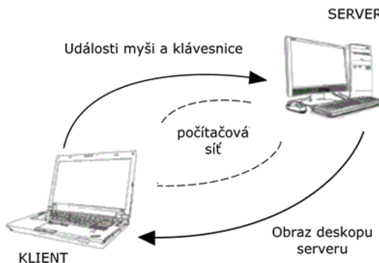
Obrázek 1 Komunikace klient – server v RD
