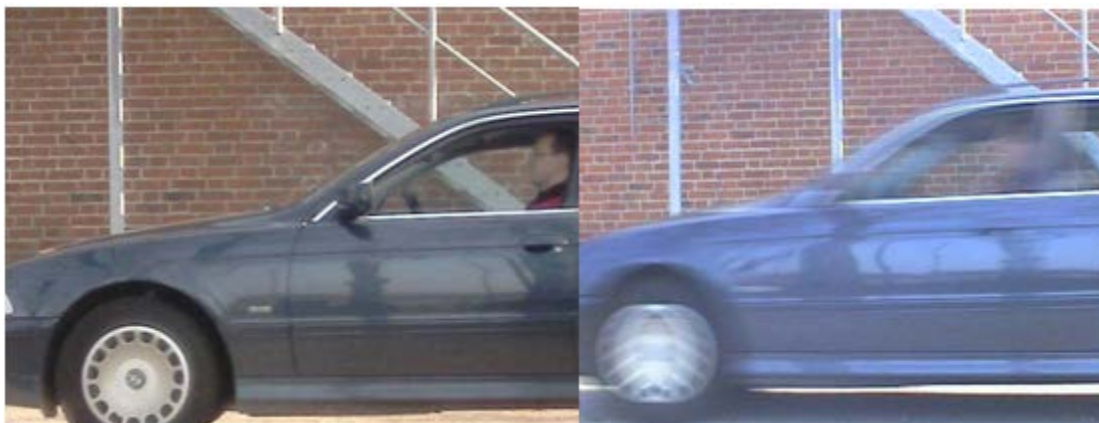
Obr. 15 Rozdíl mezi progresivním skenováním (vlevo) a prokládaným skenováním (vpravo). [8]
