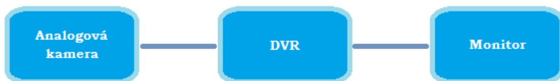
Obr. 5 Základní blokové schéma současného analogového kamerového systému. [vlastní]
