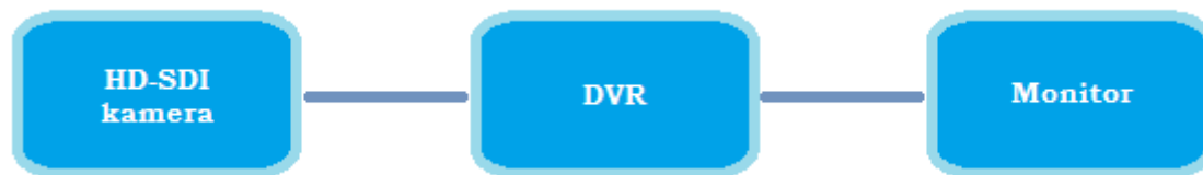
Obr. 8 Základní blokové schéma HD-SDI kamerového systému [vlastní]
