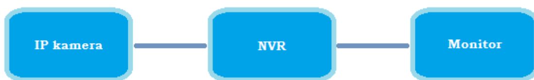
Obr. 7 Základní blokové schéma IP kamerového systému [vlastní]
