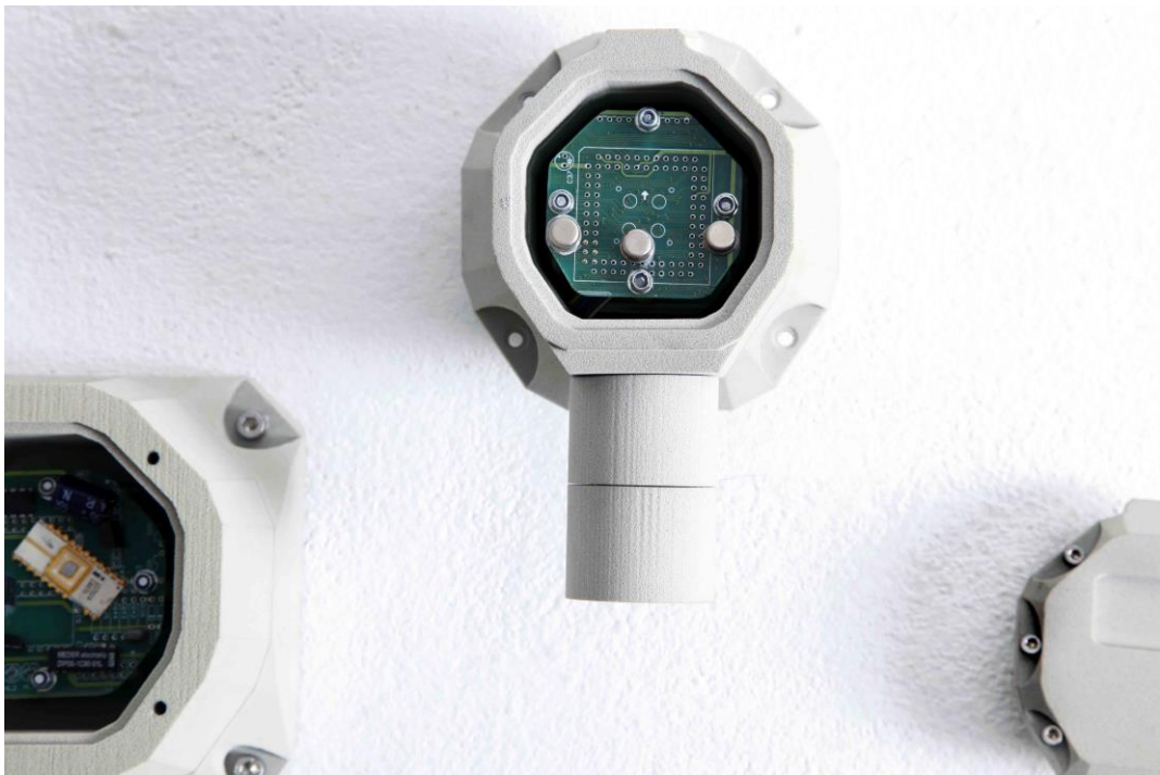
Obr. 60. Finálny model - rozloženie na jednotlivé diely - elektronika v strednej časti hlavice
