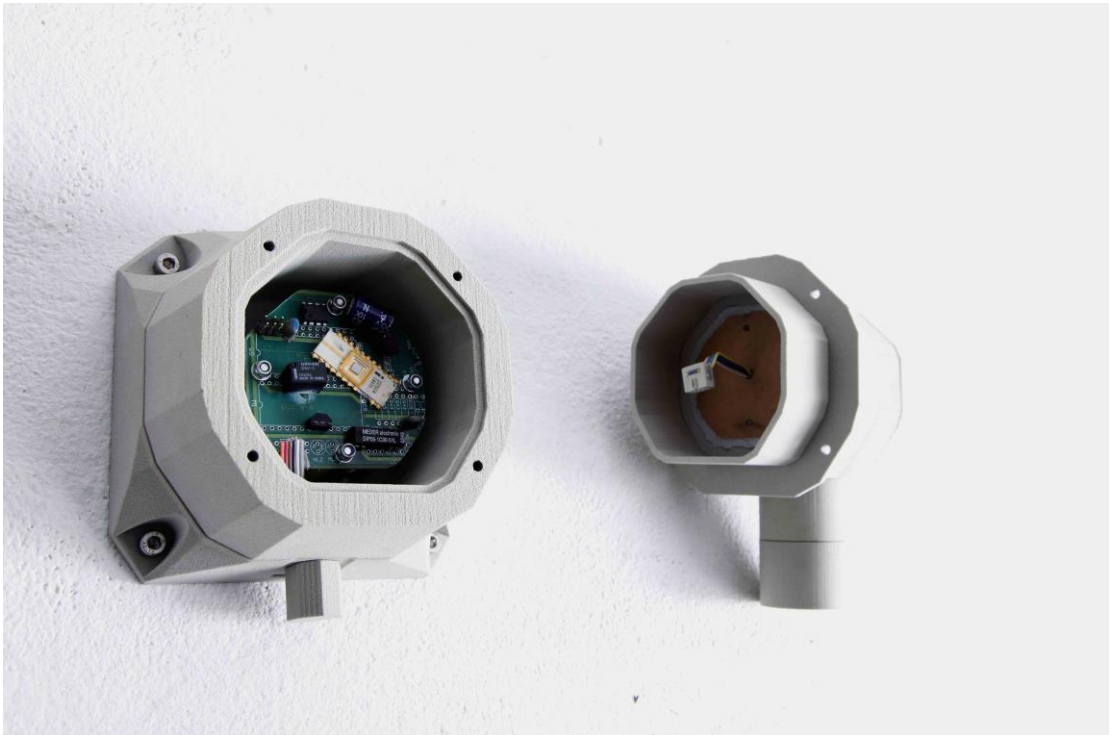
Obr. 59. Finálny model - rozloženie na jednotlivé diely - elektronika v spodnej časti hlavice
