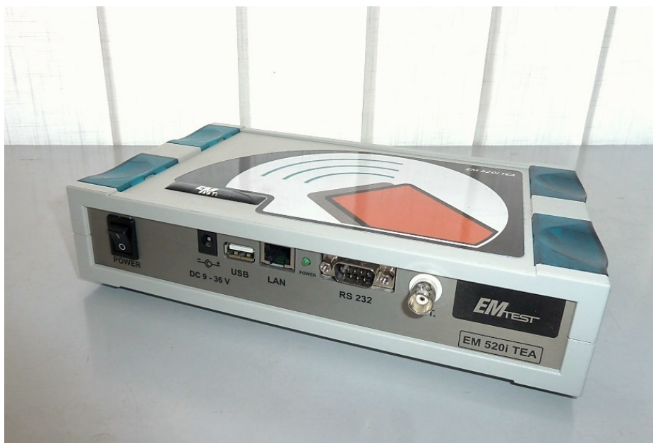
Obr. 18. Čítačka bezkontaktných kariet EM 520i TEA.
