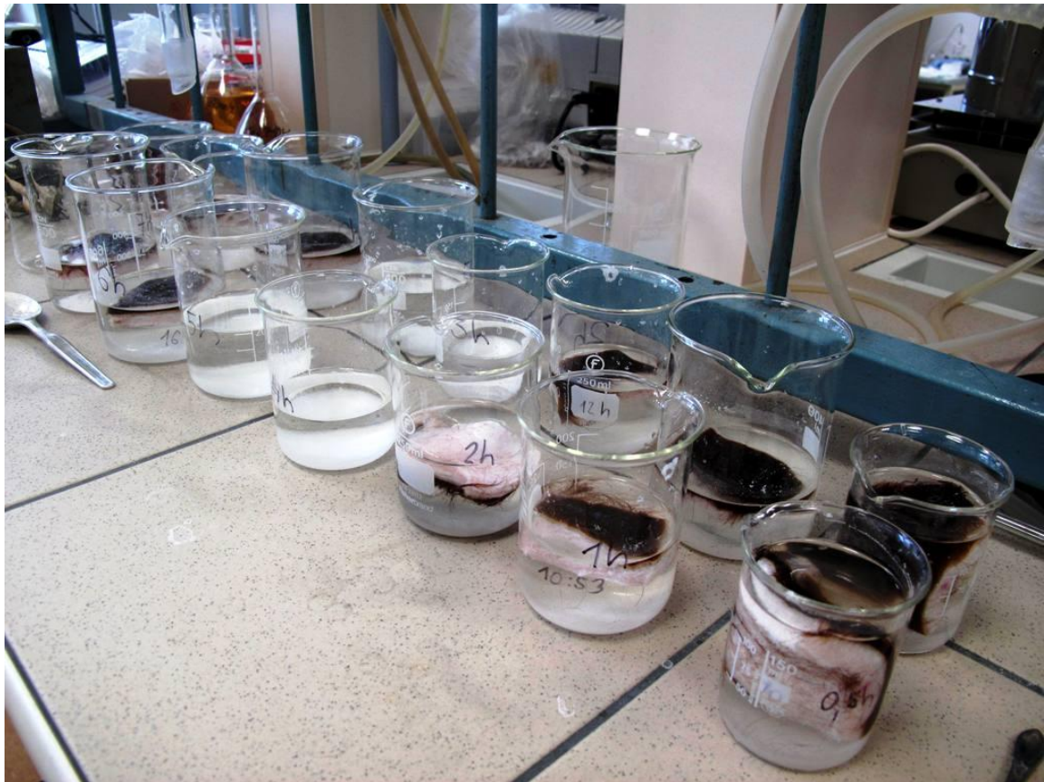
Obr. 13 Uspořádání laboratorního pokusu během testování metod barevné identifikace difúze NaCl do surových kůží pro výpočet efektivního difúzního koeficientu.
