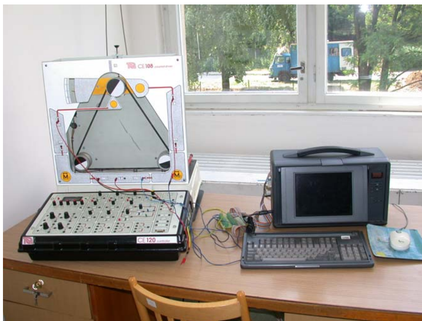
Obr. 52 Fotografie soustavy spřažených elektromotorů s připojením k PC
