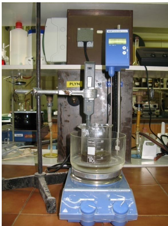
Obr. 3: Míchání směsi hydrolyzátu
