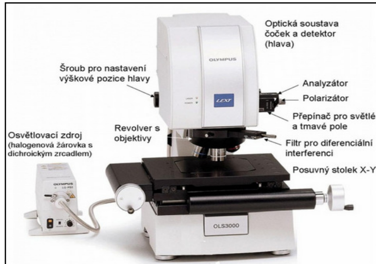
Obr. 10 Popis mikroskopu Lext OLS 3000, Olympus [12]
