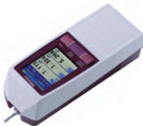
Obr. 6 Drsnoměr SurfTest SJ-210 [7]
