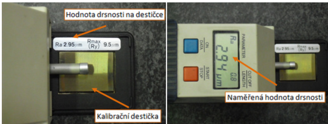
Obr. 49 Ověření správnosti měření u měřicího přístroje
