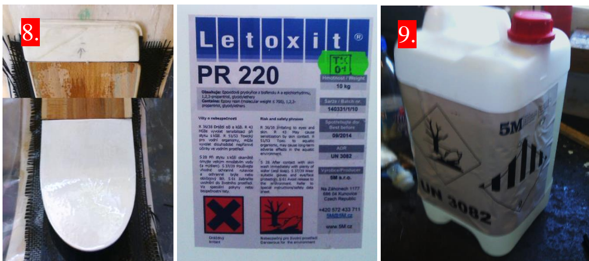
Obr. 6-5 Obrázek výztuže špičky a paty spolu s použitým lepidlem
