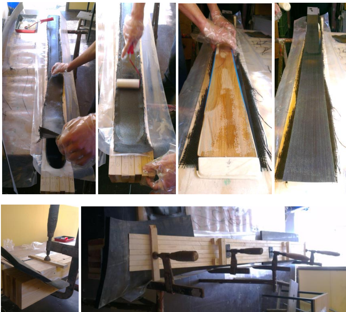
Obr. 6-10 Postup lepení lyží
