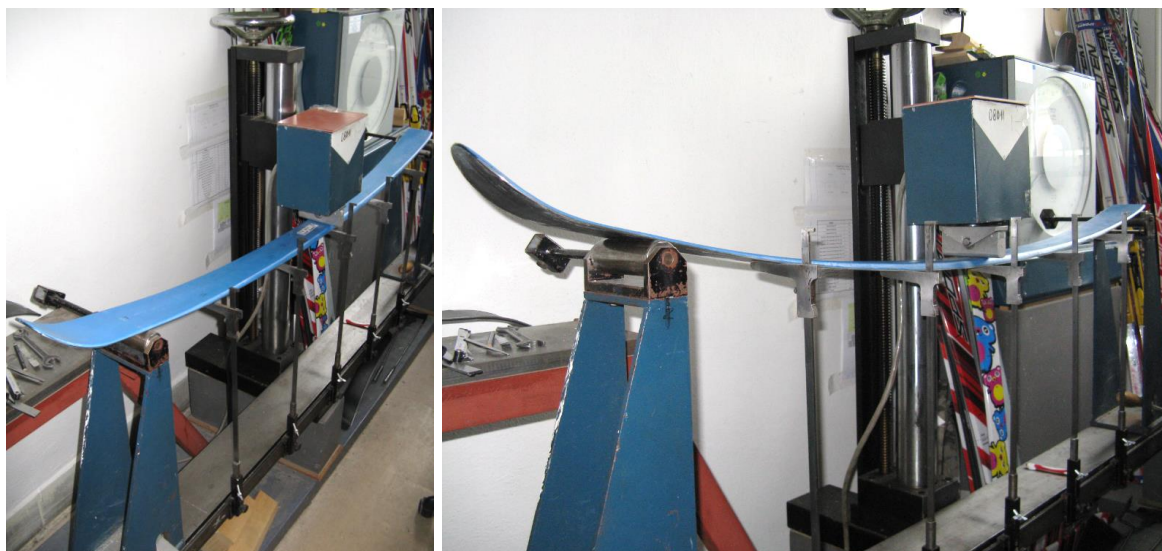
Obr. 6-13 Průběh zkoušky při stanovení konstanty pružení středu
