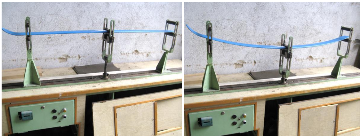
Obr. 6-15 Průběh zkoušky cyklickým namáháním
