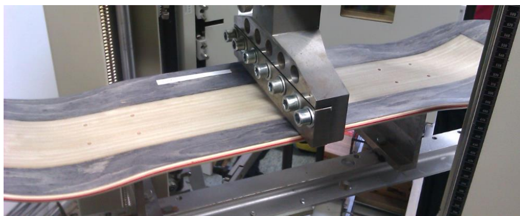
Obr. 5-3 Skateboard č. 2 – při ohybové zkoušce
