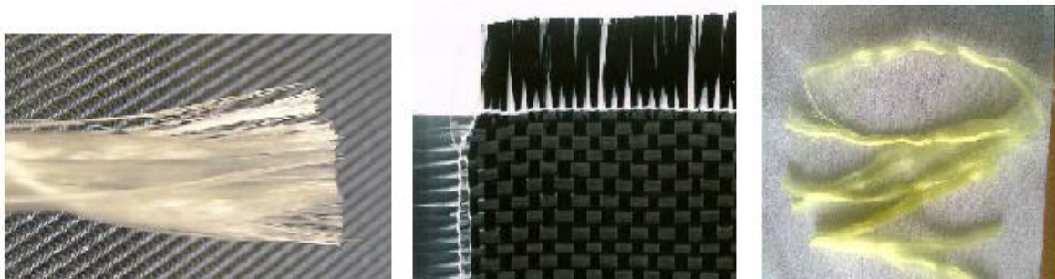
Obr. 1-9 Typy vláken (skelné, uhlíkové, kevlarové)
