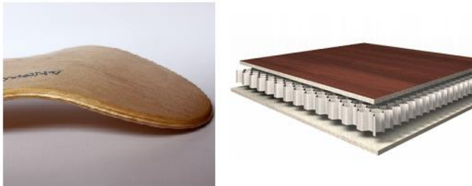
Obr. 1-6 Laminátová konstrukce skateboardu a sendvičová konstrukce s voštinovým jádrem
