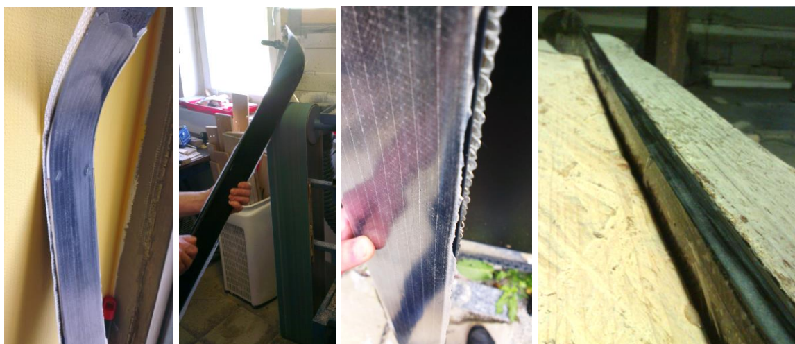
Obr. 6-11 Opracování po vytažení lyže z formy
