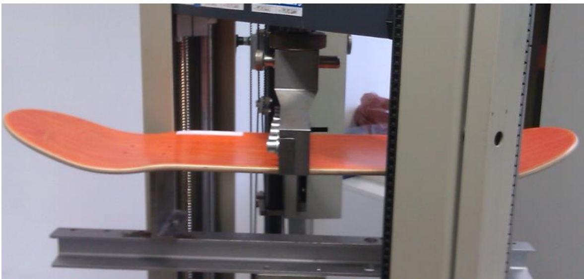
Obr. 5-5 Skateboard č. 4 – Při ohybové zkoušce
