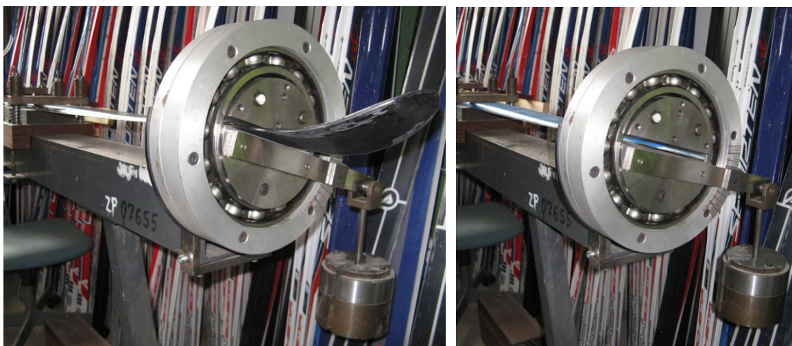
Obr. 6-14 Průběh zkoušky při stanovení torzní konstanty přední a zadní části lyže
