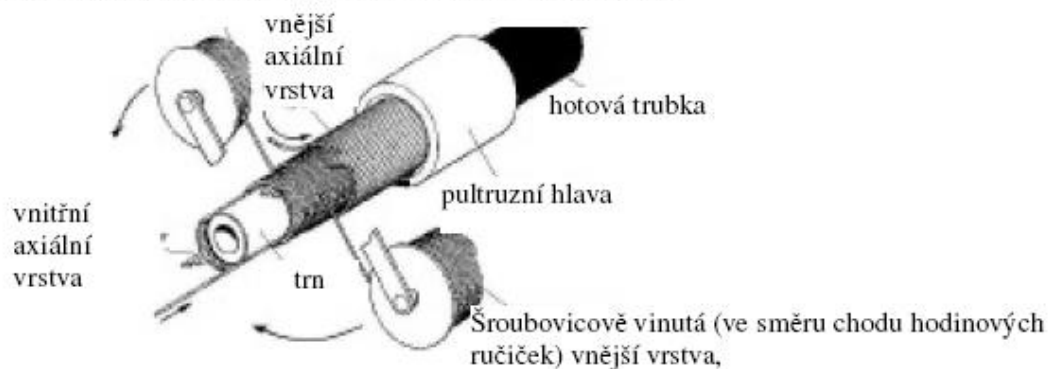
Obr.4.8 Kombinace ovíjení a pultruze tzv. Pullwinding [4]
