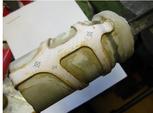
Obr. 5.3 Výroba kopyta míchání, odlévání, odformování, nalepení rozvinu košíku
