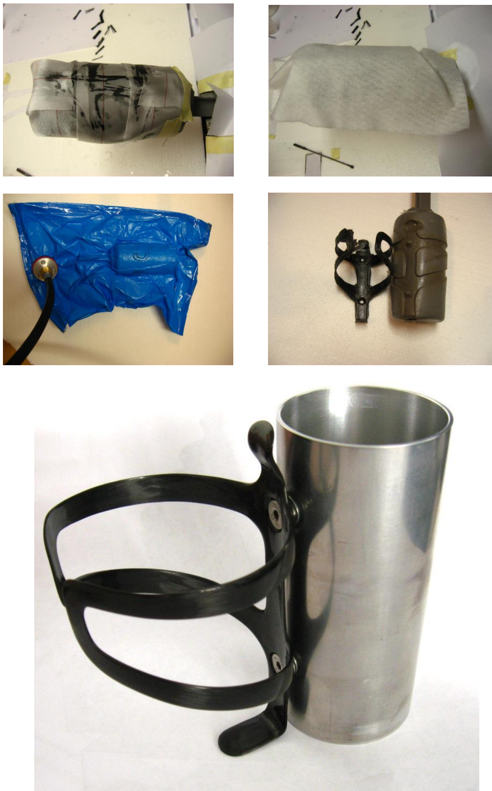
Obr. 5.6 Postup výroby košíku část B, hotový výrobek
