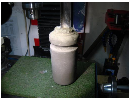
Obr. 5.3 Výroba kopyta míchání, odlévání, odformování, nalepení rozvinu košíku
