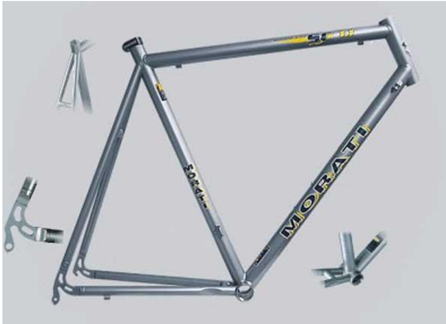
Obr. 2.3 silniční rám morati vyrobený z titanu [2]
