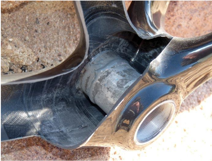
Obr.3.2 Příklad řešení přeplátování středového složení od firmy Santa Cruz [8]
