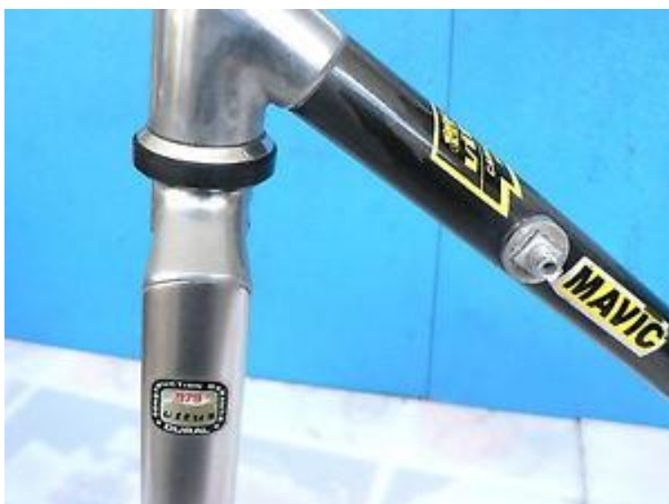
Obr.3.1 Příklad vlepení Kevlarových trubek do spojovacích hliníkových profilů u rámu Vitus 979 [8]
