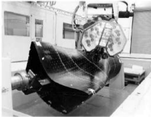
Obr.4.5 Navíjení vstupního kanálu vzduchu pro tryskový motor letadla [10]
