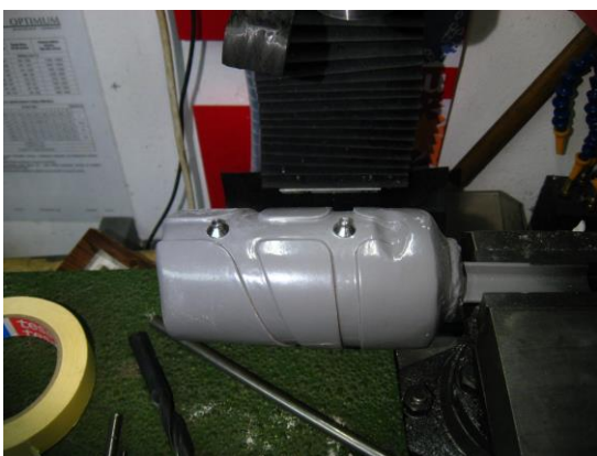
Obr. 5.4 nanesení tmelu, sejmutí rozvinu, broušení, vrtání trnů, nástřik lakem
