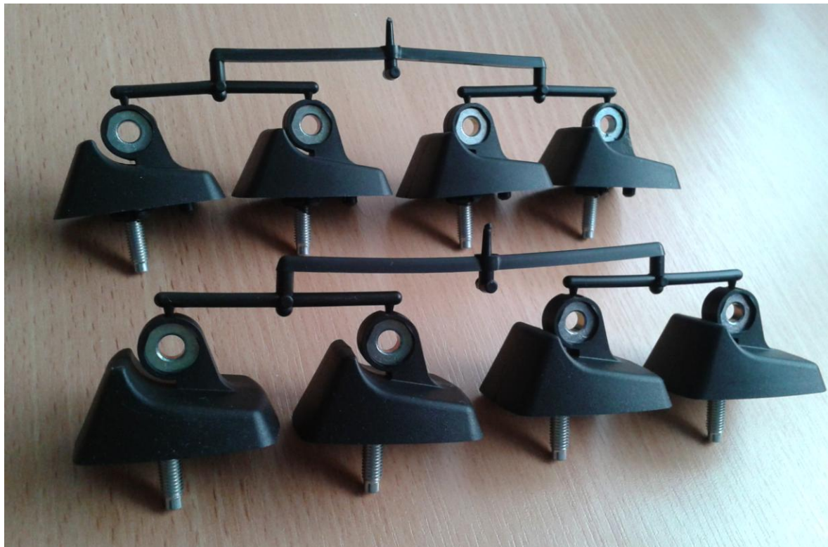
Obr. 21 Držák antény osobního automobilu – vstříkovaný výrobek
