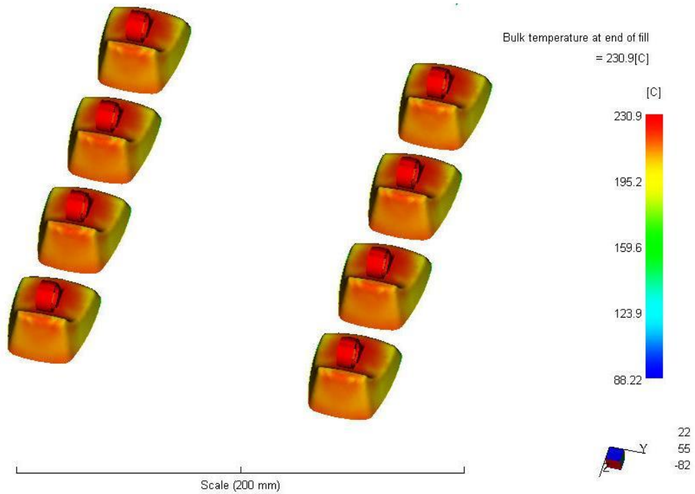
Obr. 53 Analýza teploty na konci doby plnění – původní forma
