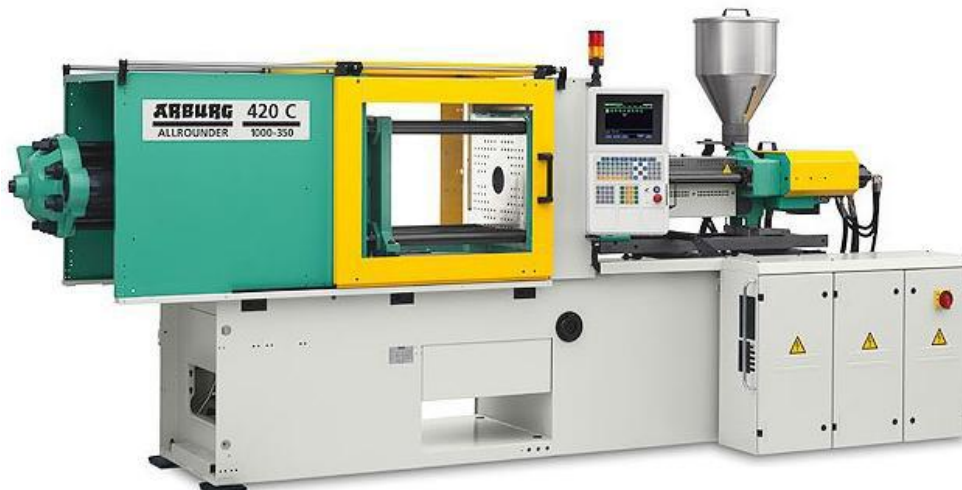
Obr. 17. Vstřikovací stroj ARBURG Allrounder 420C [28]
