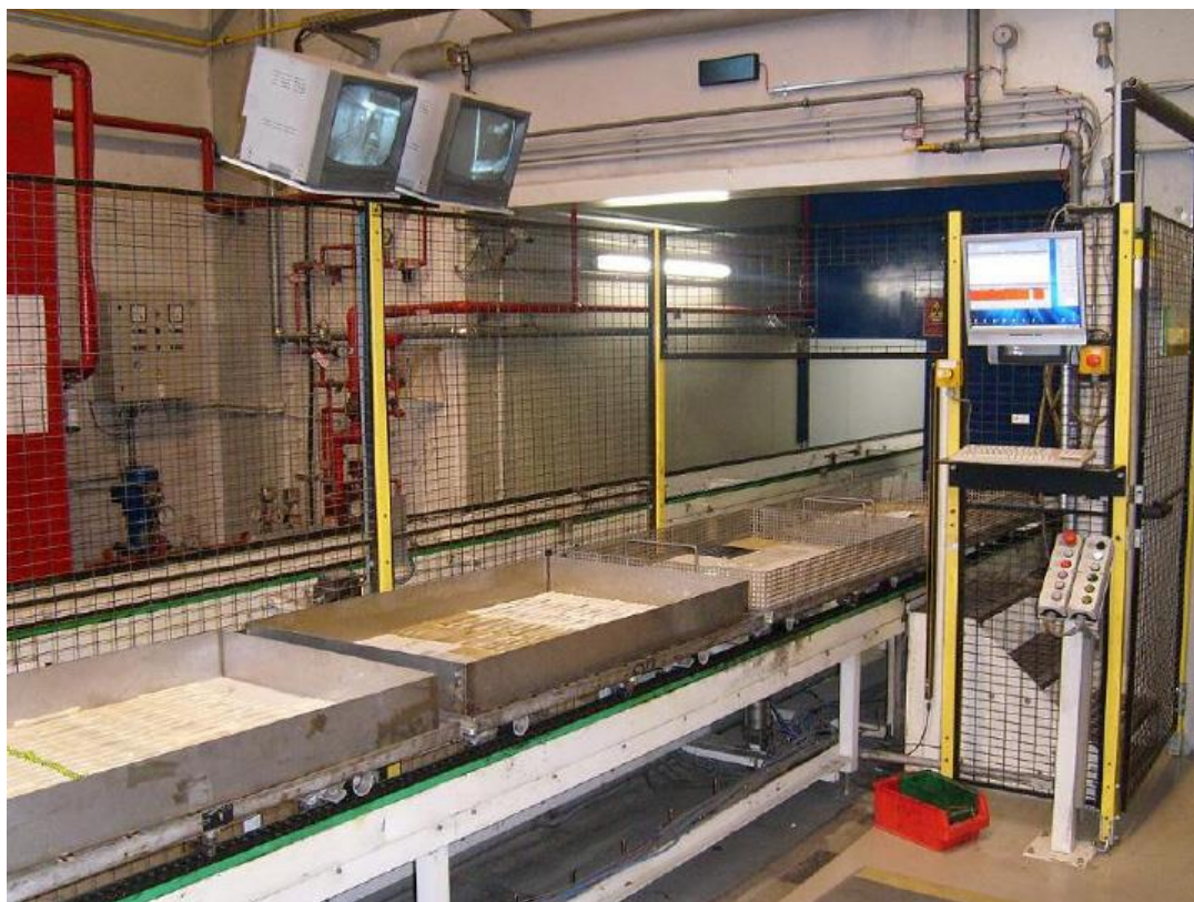
Obr. 18. Linka pro ozařování polymerů ve firmě BGS [16]
