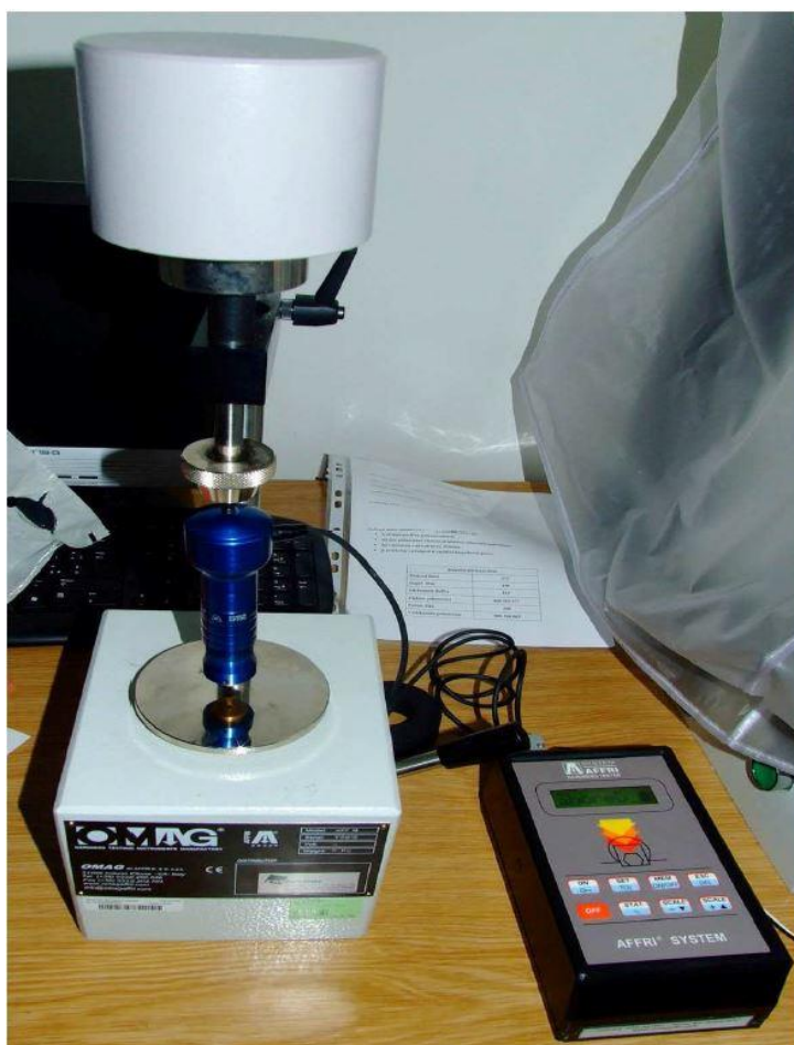
Obr. 50. Zkušební zařízení pro měření zkoušky tvrdosti dle Shoreho OMAG AFFRI RT 13
