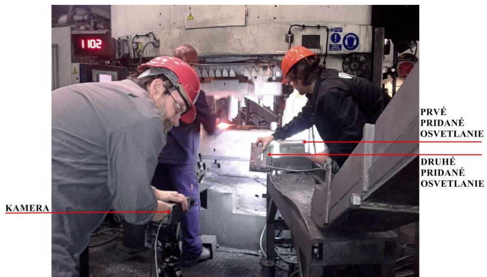
Obr. 46 Snímanie po úprave s pridaním ďalšieho osvetlenia
