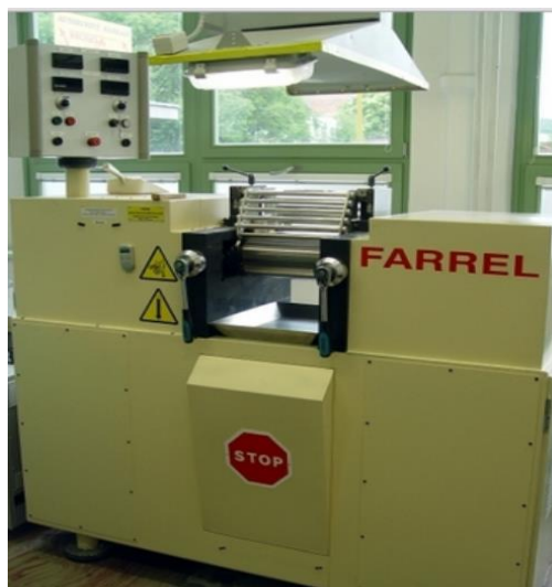
Obr. 16 Laboratorní dvouválec typu FARREL MIXING MILL 6-2605 [48]
