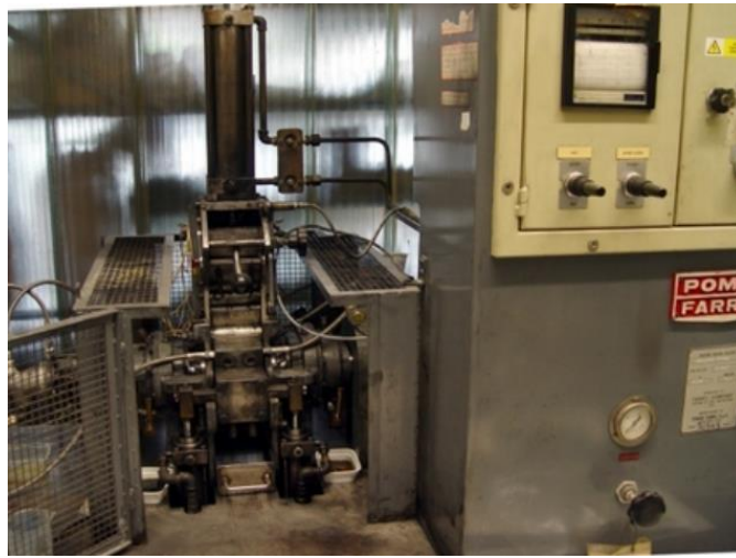
Obr. 15 Integrální hnětič typu POMINY FARREL BANBURY MIX [48]
