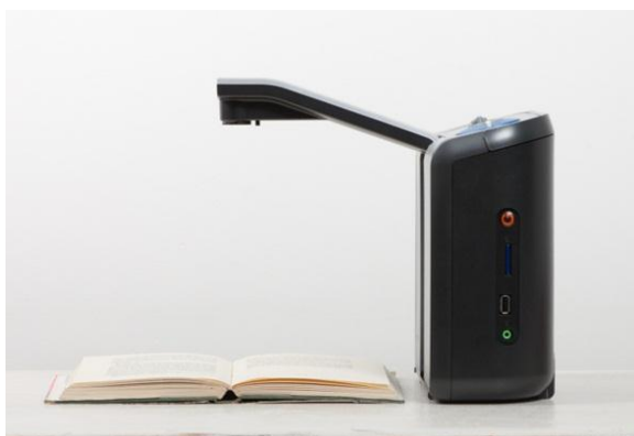
Digitální čtecí přístroj pro nevidomé s hlasovým výstupem
