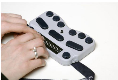
Digitální zápisník pro zrakově postižené s hlasovým výstupem nebo braillovým displejem
