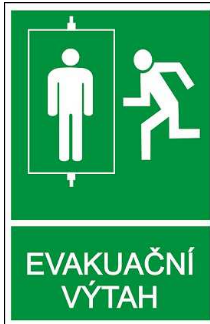
Obr. 2 Označení evakuačního výtahu Zdroj: [7]
