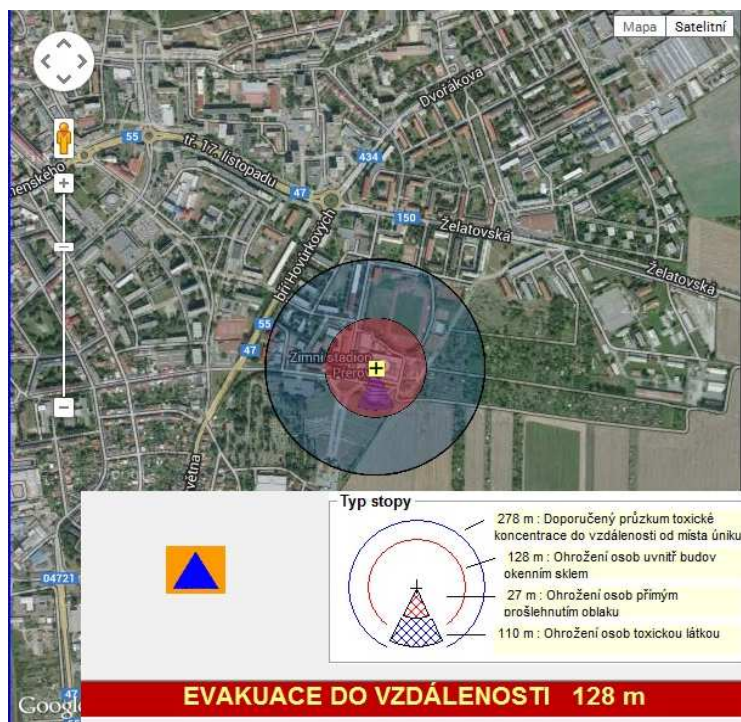
Obrázek 19 – Grafické znázornění kontaminace amoniakem při explozi zásobníku [vlastní zpracování s využitím softwaru TerEx]
