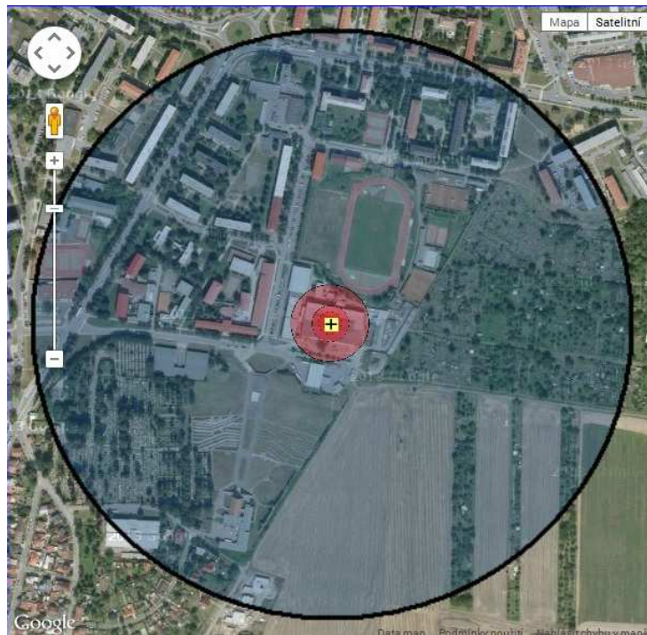
Obrázek 17 – Grafické znázornění simulace výbuchu výbušného systému [vlastní zpracování s využitím softwaru TerEx]
