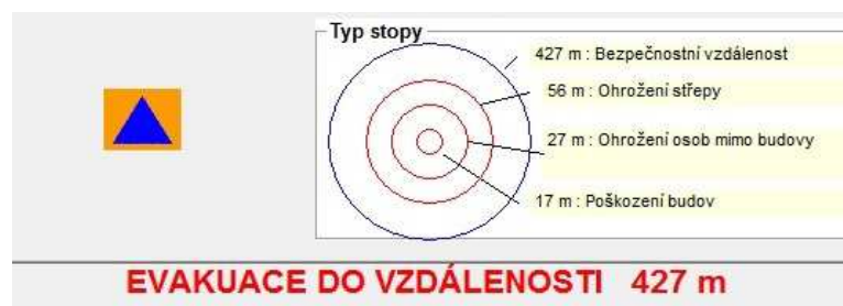
Obrázek 16 – Zobrazené zóny dopadu simulace výbuchu výbušného systému [vlastní zpracování s využitím softwaru TerEx]
