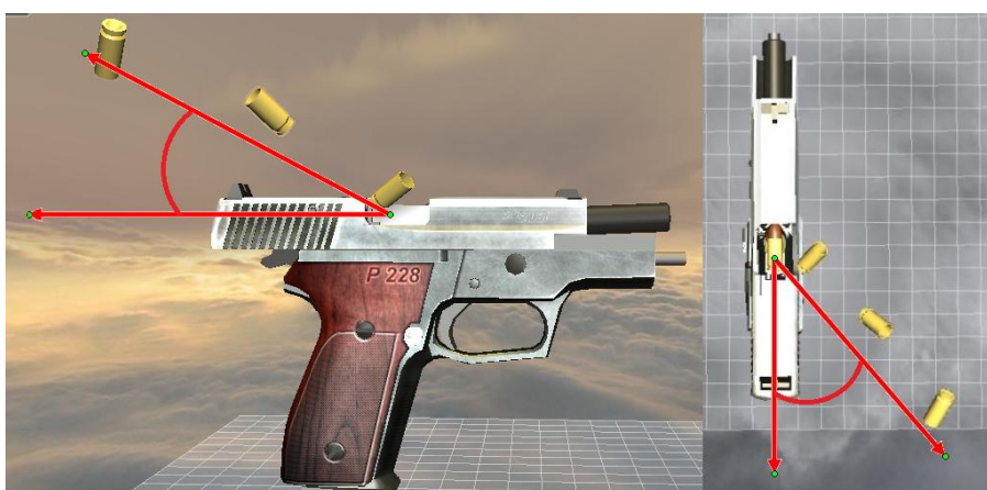
Obr. 7 Zobrazení úhlů vyhozených nábojnic pistolí Sig Sauer P 228 18
