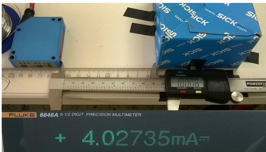
Obr. 26: Naměřený proud při vzdálenosti snímače přibližně 100 mm
