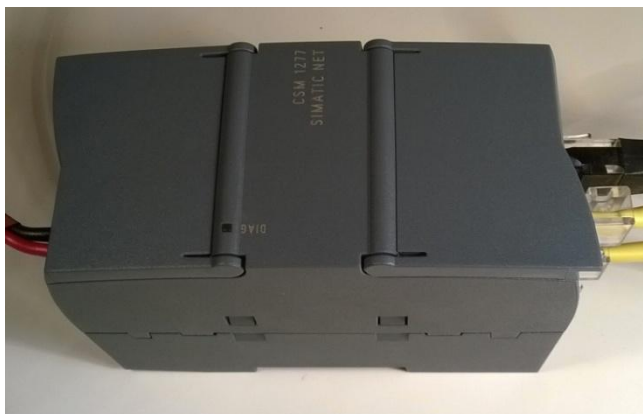
Obr. 15: Čtyř portový Switch CSM 1277
