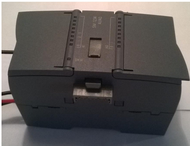
Obr. 13: Signálový analogový modul SM 1234 AI/AQ
