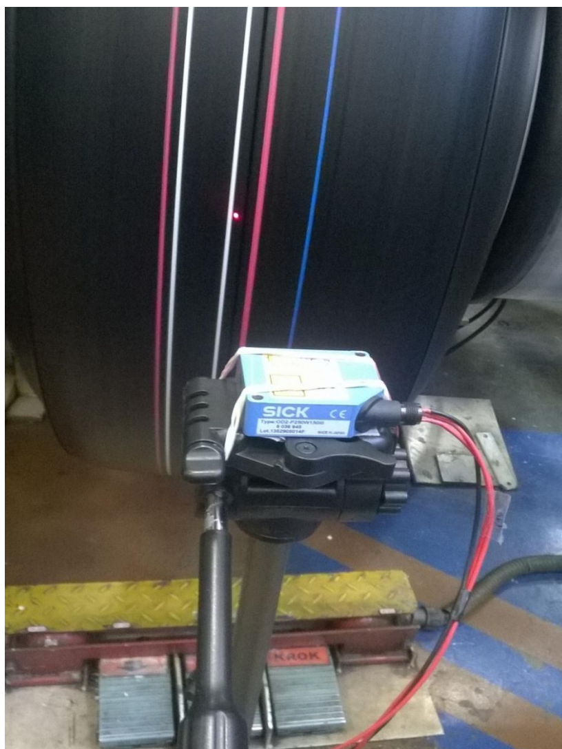
Obr. 35: Snímač vzdálenosti při měření obvodu rovníku surového pláště
