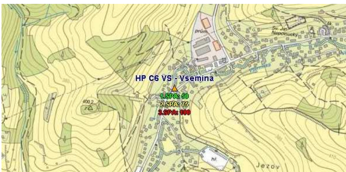
Obr. 12: Hlásný profil C6 VS a stavy hladiny na čidle v cm určující SPA [23]
