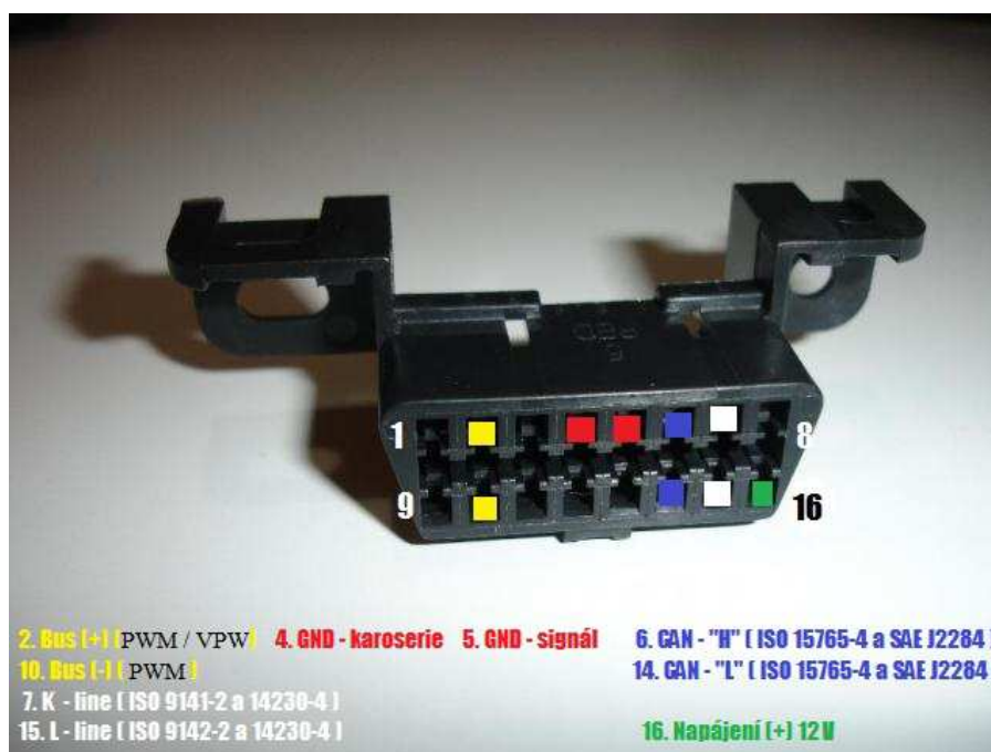
Obr. 5: DCL konektor (OBD II) [17] - upravil Slováček (2014)
