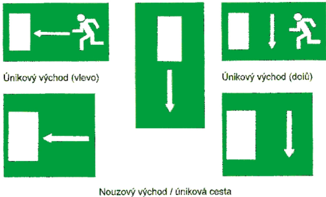
Obrázek 21 Označení únikových cest a nouzového východu [Zdroj: 20]
