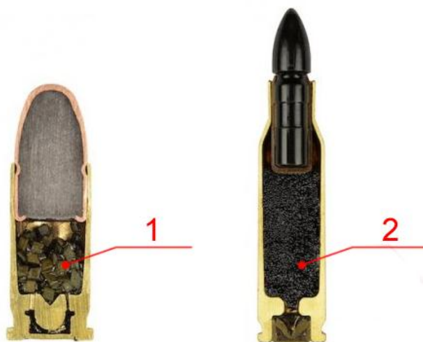
Obr. 3 Průřez náboje s hnací složi, Pistolový náboj (1) a puškový náboj (2) [8]
