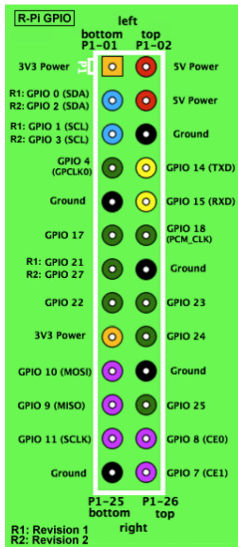
Obr. 32 Rozloženie GPIO [37]
