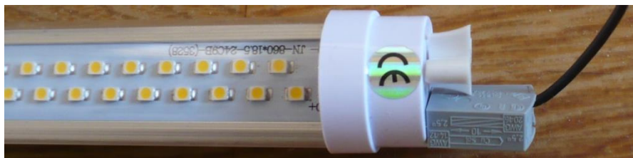
Obr. 38 Detail pripojenia LED trubice cez WAGO224-101
