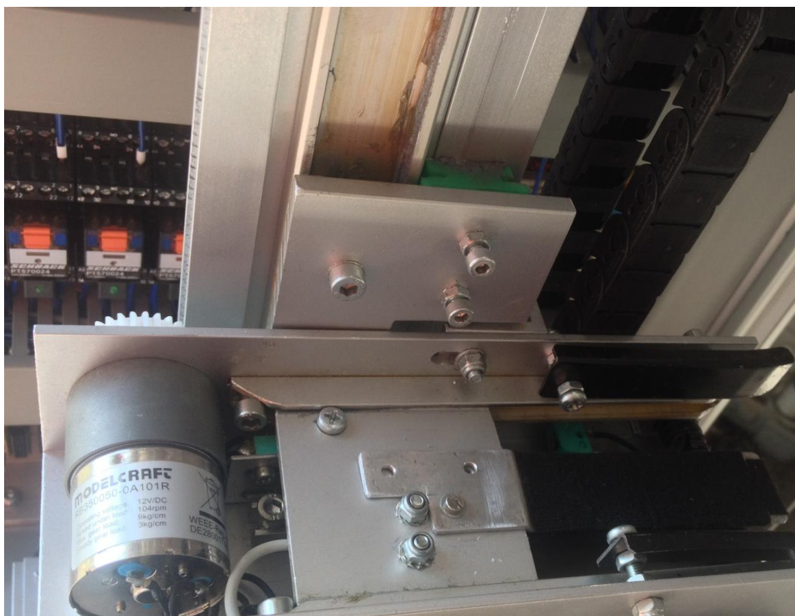
Obr. 22 Původní řešení pohybu zakladače palet v ose y
