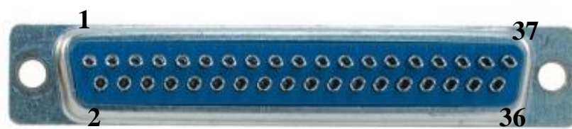
Obrázek 9 37 pinový CANON konektor pro externí panel
