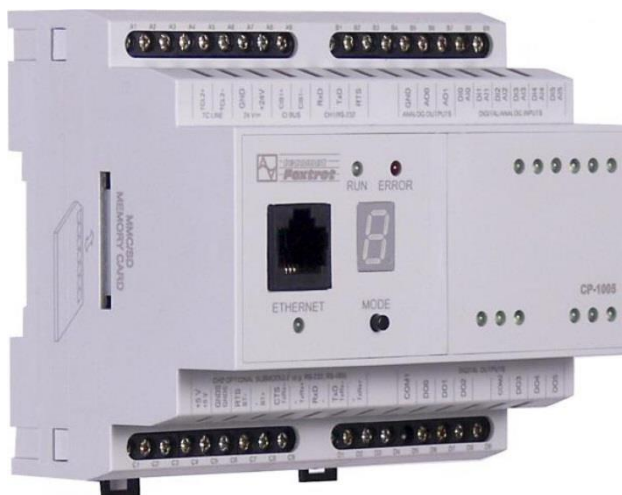
Obr. 16: Programovatelný automat Foxtrot CP – 1005. [16]
