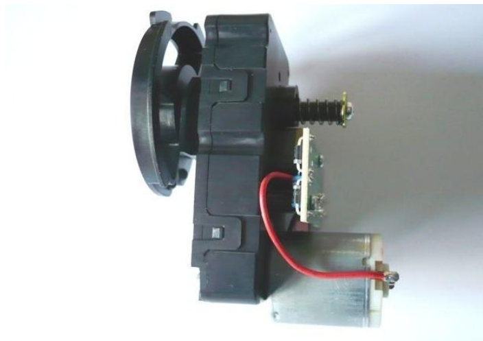
Obrázek 21- Fotografie pohonu výdejového zařízení
