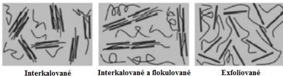
Obr. 11 Schéma morfologického uspořádání polymerní matrice obsahující MMT [23]
