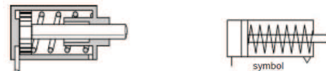
Obrázek 26: Jednočinný pneumatický válec s pístnicí v klidové poloze zasunutou[3]
