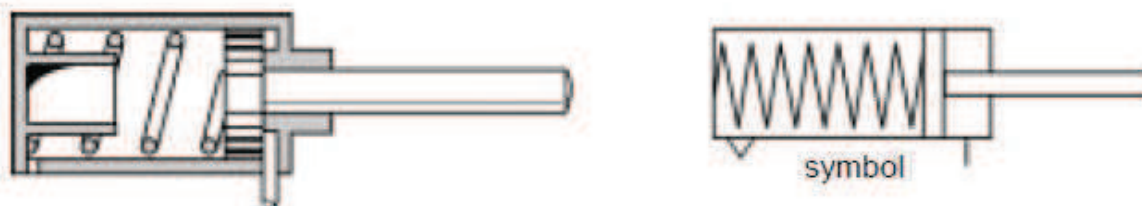
Obrázek 27: Jednočinný pneumatický válec s pístnicí v klidové poloze vysunutou [3]
