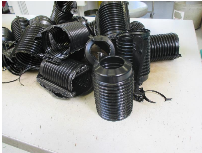
Obrázek 30: Neopracovaný kryt tlumiče
