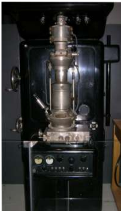
Obr. 1. Ruskův elektronový mikroskop z roku 1933 [4]
