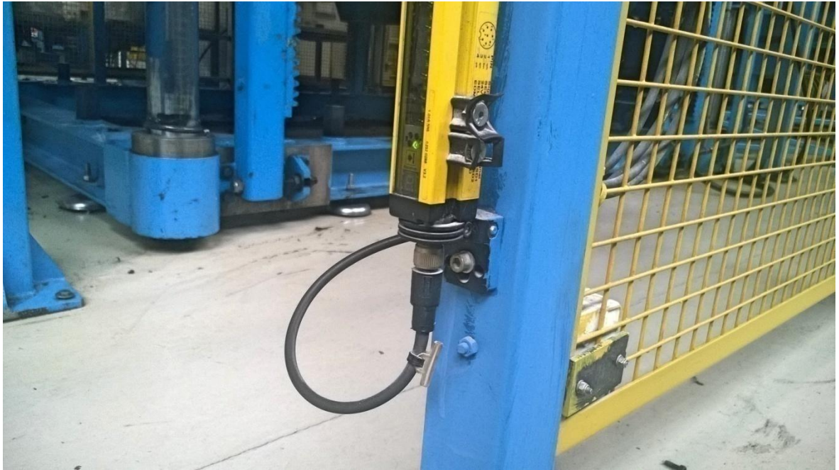
Obrázok 37 – Svetelná bezpečnostná závora (vlastné spracovanie)
