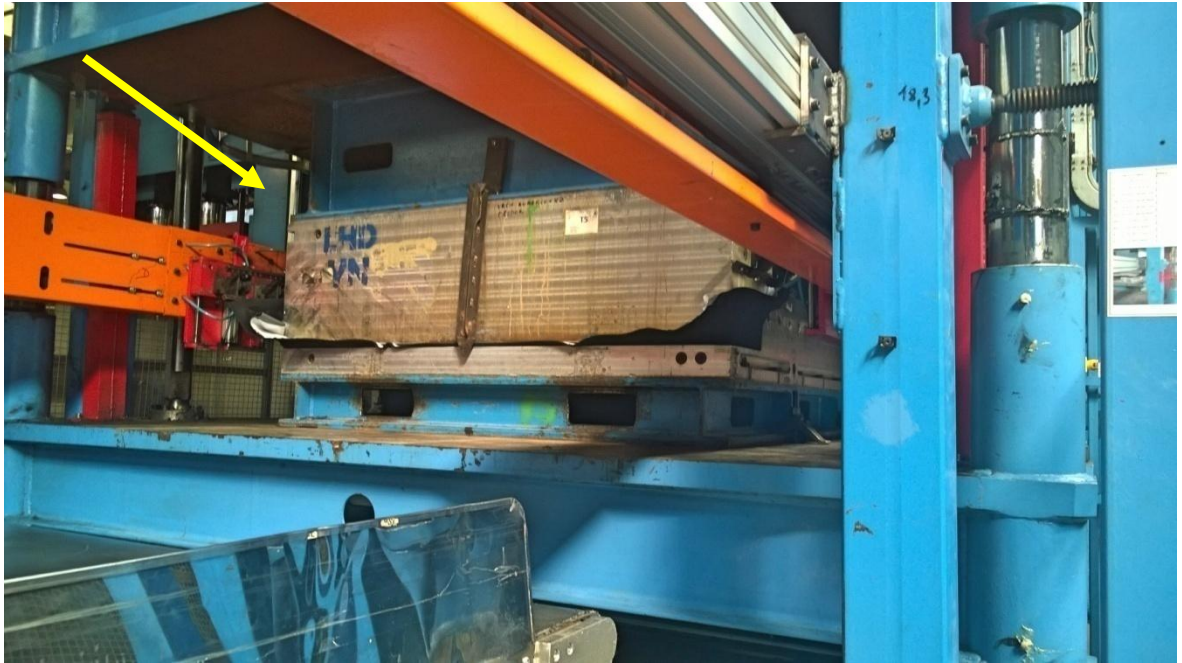
Obrázok 31 – Forma zasadená v lise (vlastné spracovanie)
