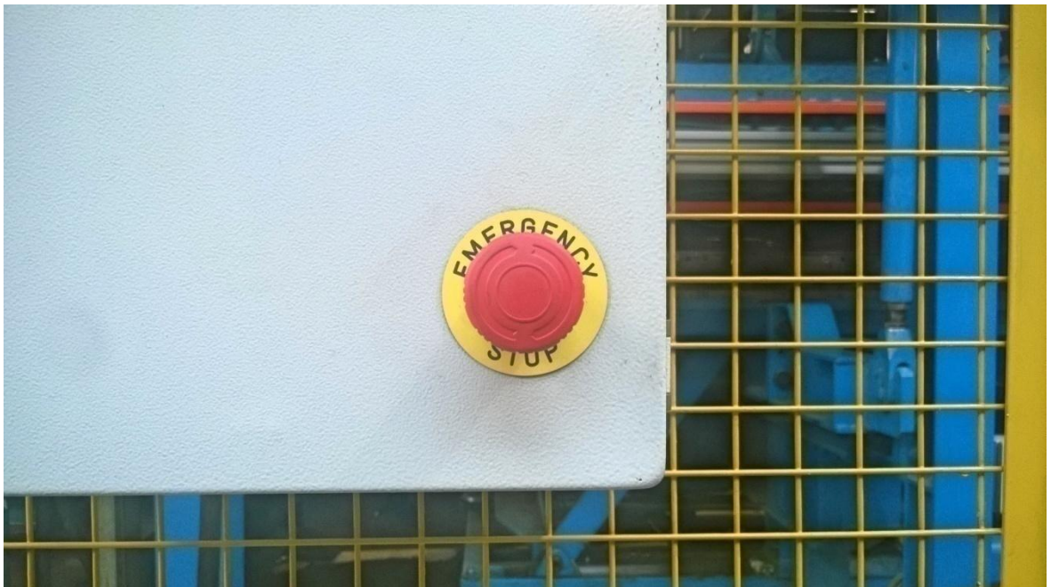
Obrázok 38 – Total stop tlačidlo (vlastné spracovanie)
