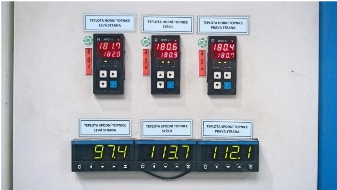
Obrázok 17 – Nastavenie teplôt ohrevu žehličky (vlastné spracovanie)
