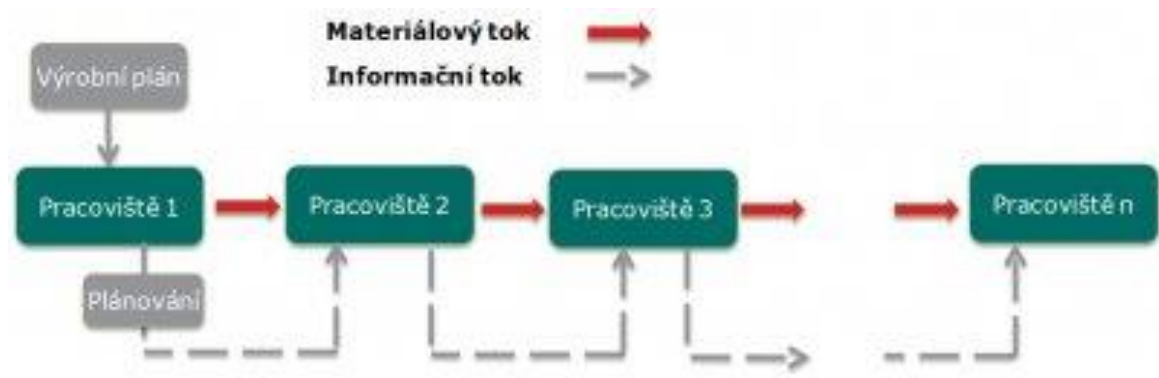
Obrázek 3 – Princip systému tlaku (API, 2015)
