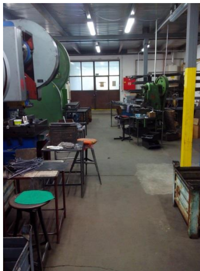
Obrázek 38 Neexistující ohrazení pracovišť (vl. foto)
