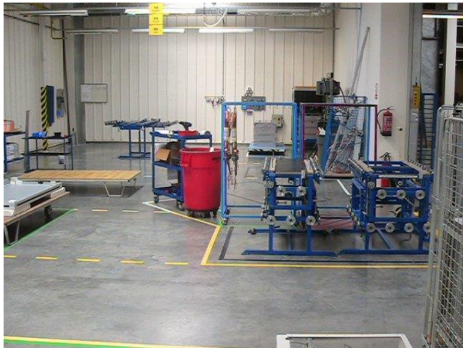
Obrázek 49 Způsob, jak by mělo vypadat ohraničení pracovišť (e-api.cz)
