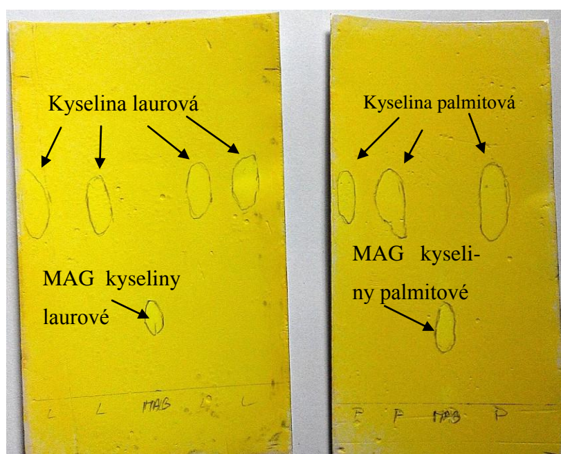
Obr. 11: Chromatografické desky TLC analýzy MAG kyseliny laurové a MAG kyseliny palmitové (vyvíjecí soustava – chloroform/voda/kyselina octová: 95/4,5/0,5).
