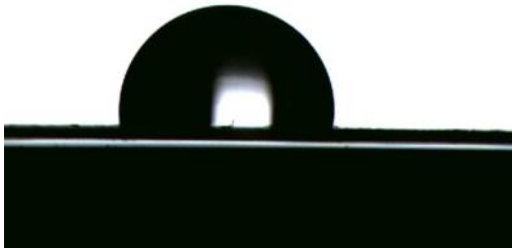
Obr. 41 Nanesená kapka roztoku vzorku A na hydrofobní části parafilmu
