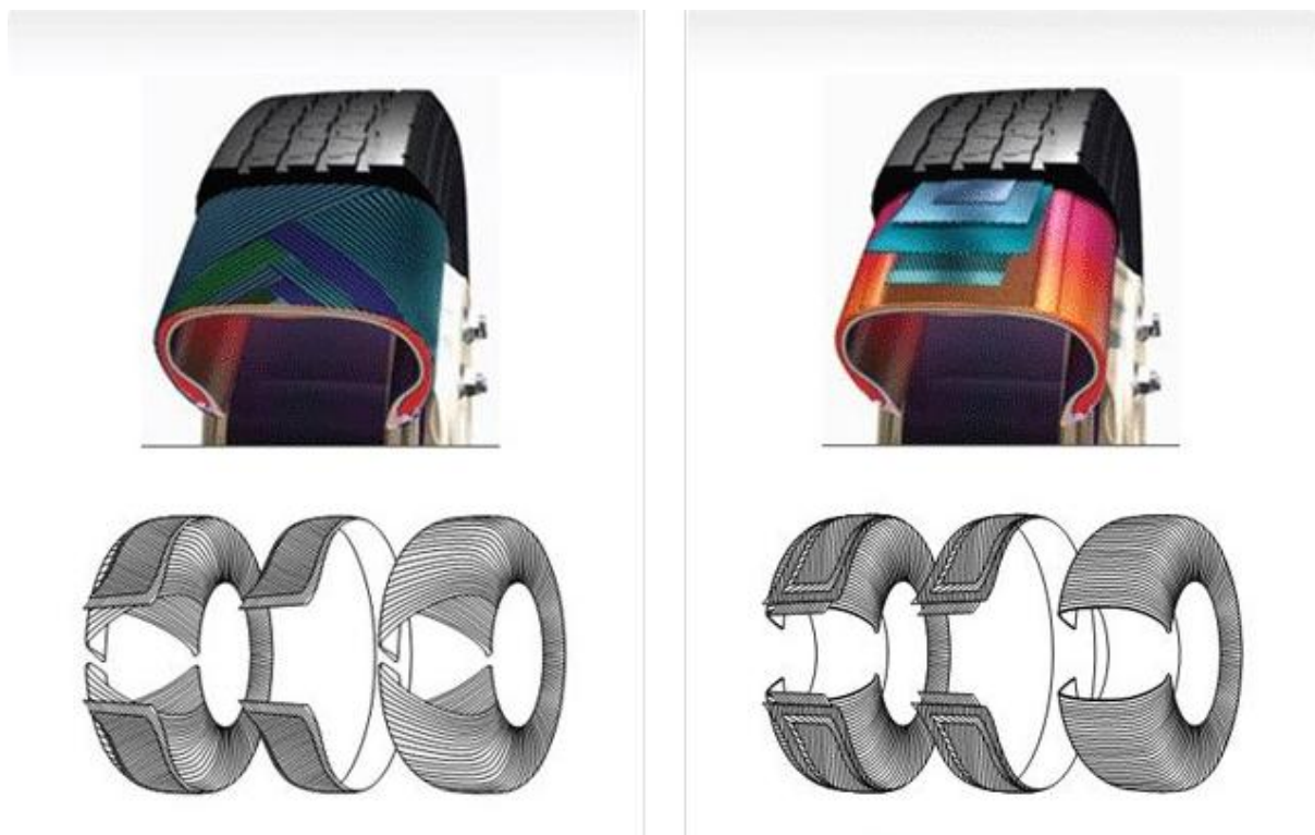
Obrázek 3: Vlevo – diagonální plášť pneumatiky, Vpravo – Radiální plášť [11]
