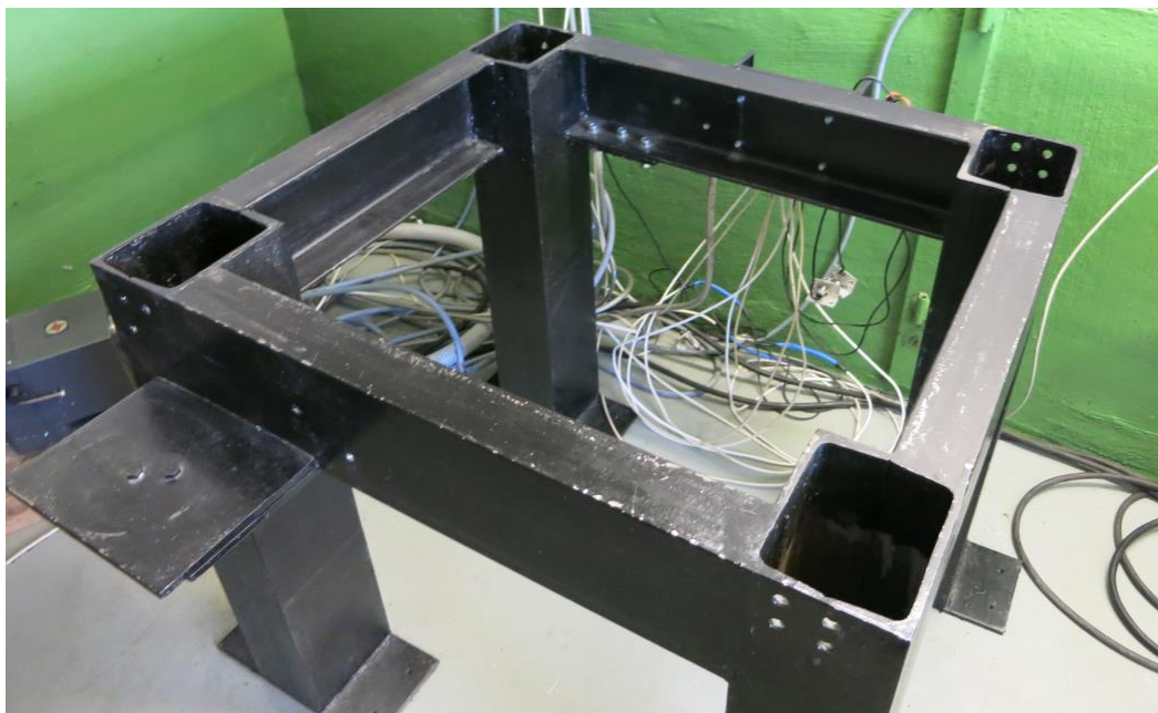
Obr. 44 Fotografie svařeného rámu stroje
