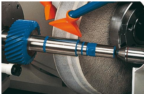
Obr. 8 Broušení vnějších průměrů šikmým zápichem na stroji EJ 3 [22]
