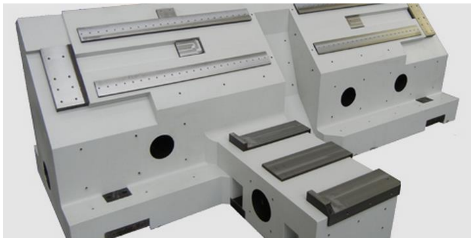
Obr. 23 Základní rám stroje z polymerbetonu [29]
