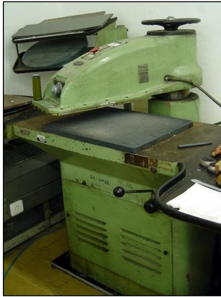
Obrázek 7 Hydraulický vysekávací stroj ZPS 06102 P1 pro vysekávání vzorků, které byly předmětem měření.
