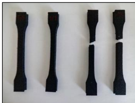
Obrázek 31 Vyseknuté lopatky před zkouškou a po zkoušce (vpravo).
