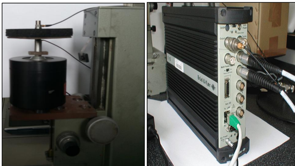
Obrázek 36 Foto aparatury – vibrátoru přenosového útlumu (vlevo), vpravo multi-analyzátoru pro měření signálu akcelerometrů.
