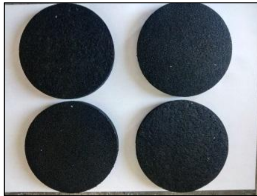
Obrázek 34 Foto vyseknuté vzorky pro tlakovou zkoušku (vpravo).
