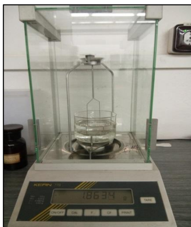
Obrázek 41 Foto digitální váhy v uspořádání pro měření hustoty.
