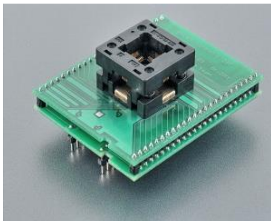
Obrázek 25 Adaptér TQFP 48pin + parametry pouzdra [30]
