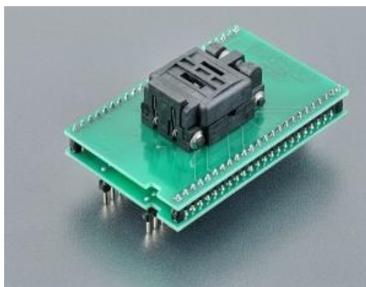
Obrázek 26 Adaptér QFN 48pin + parametry pouzdra [30]
