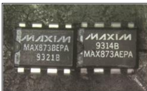
Obrázek 3 Vlevo pravá součástka, vpravo padělek [7]
