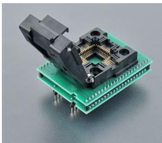
Obrázek 27 Adaptér PLCC 44pin + parametry pouzdra [30]
